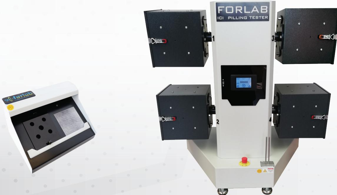
Kumaş üzerinde normal giyim şartlarından kaynaklanan boncuklaşma ve ilmek çekmesinin tespitinde kullanılır. Poliüretan numune tüpleri, cidar mantarları, işaretleme şablonu, kesme aparatı, numune bandı ile birlikte komple set halindedir. Cihaz orijinal olarak 2 veya 4 kutu ile tasarlanmıştır ve çift dönüş hızı 30 veya 60 rpm'de ayarlanabilir. Dönen kutular özel ve akıllı bir kapakla korunmaktadır.
